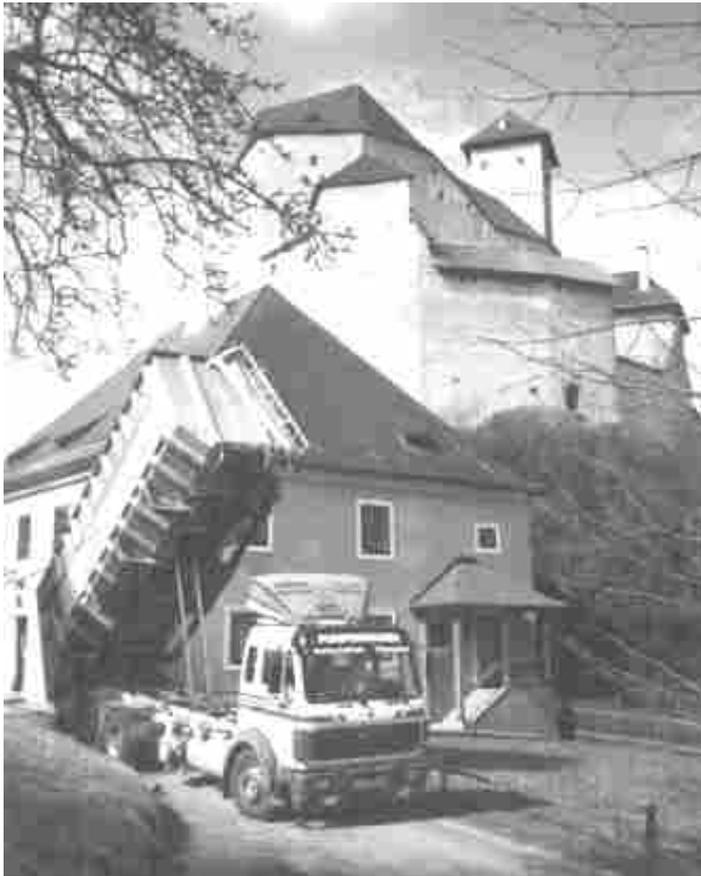
gleich bleibt, der Trend zu Pellets aber bemerkbar steigt, wird ein Einstieg in diese Richtung in Erwägung gezogen. Dazu müsste aber der Pumpen-LKW umgerüstet werden, damit die gepressten Sägespänestoppeln unbeschädigt bleiben, was für ein einwandfreies Funktionieren dieser Heizanlagen von Wichtigkeit ist.
